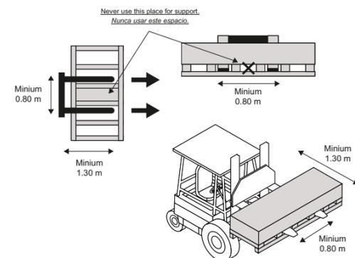
Para una correcta manipulación de los cajones, se utilizará una carretilla elevadora o transpaleta manual. Se recomienda manipular el cajón por la parte ancha del mismo con las palas de al menos 1,20m de longitud. Nunca se debe utilizar el hueco central para cargar.
